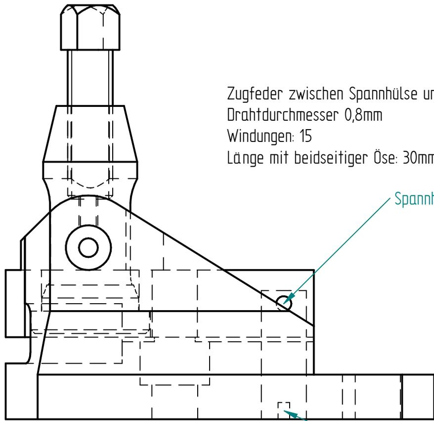
Zugfeder zwischen Spannhülse und Zylinderstift eingehängt
