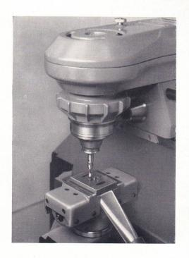
Verstellbarkeit der Schleifspindel 0,1 — 8 mm  $\phi$ . Schleifbereich ca. 4—60 mm  $\phi$ . Durch Auswechseln der Riemenscheibe und Antriebsgurte kann der Schleif-
