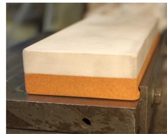
*Abziehen einer Magnetplatte, die Lippe reicht bis unter die Anschlagsschiene*
